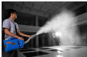
Nebulizzatore Atomizzatore ULV 1000W, capacità serbatoio di 5 litri, facile da usare, adatto per pesticidi e sanificazioni.
